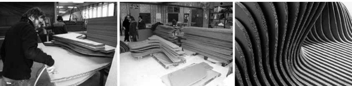
Abb. 5: CNC-Fertigung der Segmente mittels Wasserstrahlschneiden und Detail der Segmente des Messestands
