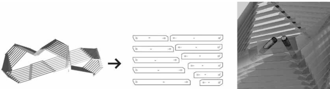
Abb. 7: Transfer der digitalen Geometriedaten zu 2D-Daten für die Spanten und 3D-Daten für die Abstandshalter der Knoten
